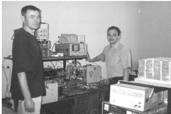
Несколько лет назад, делали источник питания для испытания спутников на электромагнитные помехи – генератор электростатического разряда.
